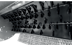
可快换的尖状定刀 可在作业过程中 调整粉碎效果
