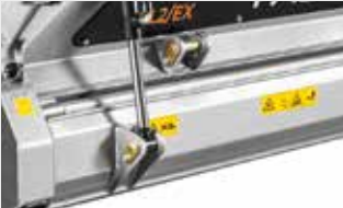
液压前机罩 实现最佳粉碎效果，减少粉碎物的喷出
