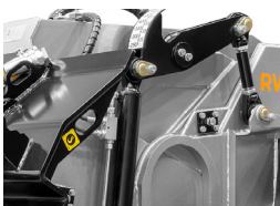
深度指示器 用于精确的深度控制
