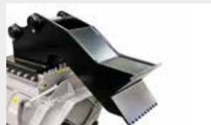
带固定抓钳的定制连接支架
