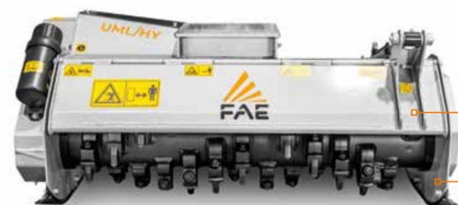
钢定刀有助于将材料粉碎成更小的尺寸
