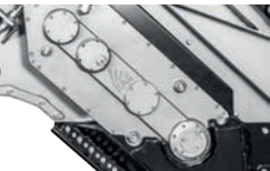
配备侧齿轮箱的双传动箱 可将更大的动力输送至刀鼓
